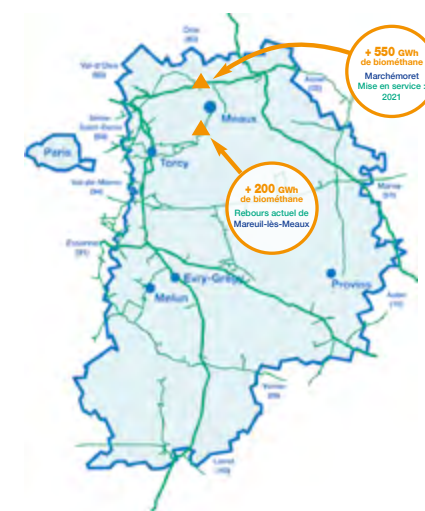
L'installation de rebours, une solution pour maximiser la production de gaz renouvelable en Seine-et-Marne.
